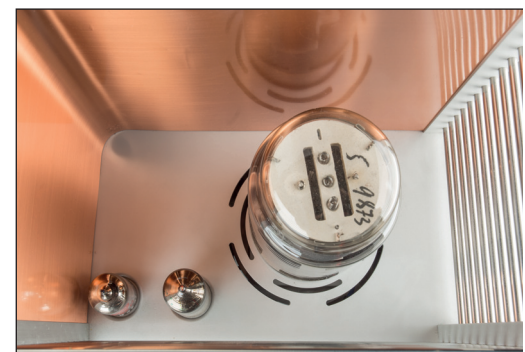
Hier sieht man's besser: Die GM70 ist eine echte Triode und eine der letzten Entwicklungen bei Leistungsröhren aus Glas
